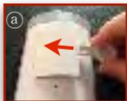
Retirer le couvercle du compartiment à piles en introduisant la clé en plastique fournie dans la fente latérale du volet et en poussant dans le sens indiqué par la flèche (a).
